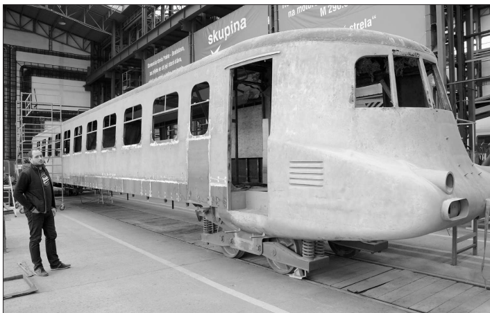
Pouze skelet Slovenské strelly je aktuálně v dílnách Českomoravských železničních oprav v Hranicích. Další části unikátního vlaku se renovují různě v ČR. FOTO: DAVID MACHÁČEK
