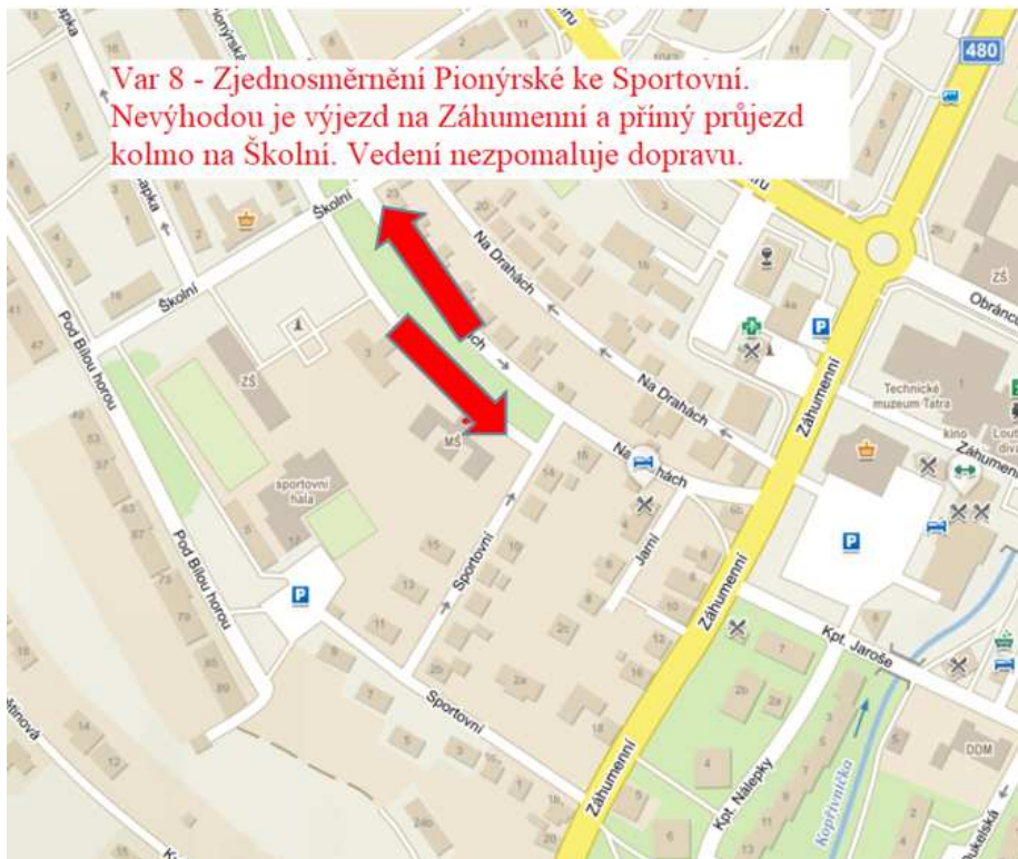
Obrázek 26 Návrh jednosměrky Pionýrské ke Sportovní a Na Drahách ke Školní schéma, varianta 8
